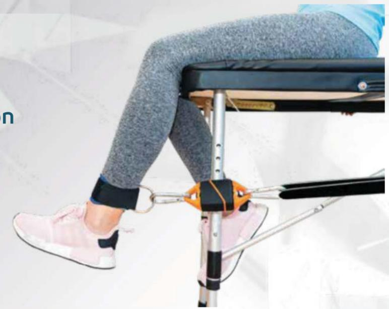
Dynamomètre de traction pour l'appréciation et le travail de la force musculaire en isométrie comme en dynamique (élastiques, iso-inertiel, TRX...). Le link permet une mesure non opérateur-dépendant.
